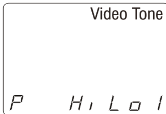
Рисунок 12. Тестирование видеокабеля с выбранной передачей сигнала по центральному проводнику.
