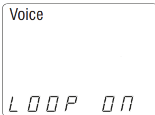
Рисунок 5. Циклическое тестирование в режиме голосового кабеля.
