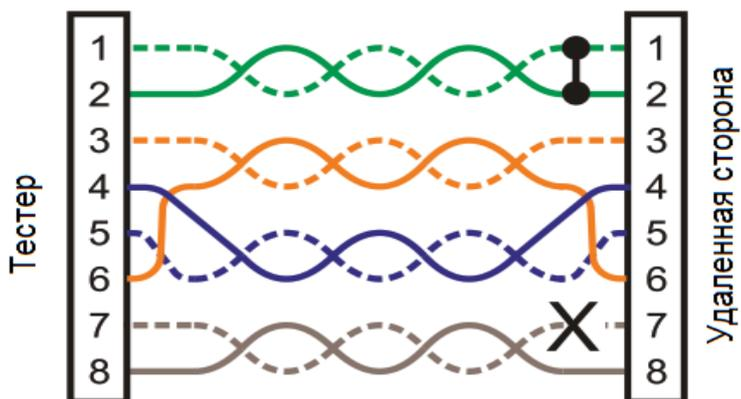
Контакты пары 1-2 закорочены, а пара 7-8 имеет обрыв. Контакты с ошибками мигают на дисплее. Черточки (-) в нижней строке дисплея (удаленная сторона кабеля) указывают на короткое замыкание, в то время как отсутствие номера в нижней строке указывает на пару с обрывом.
