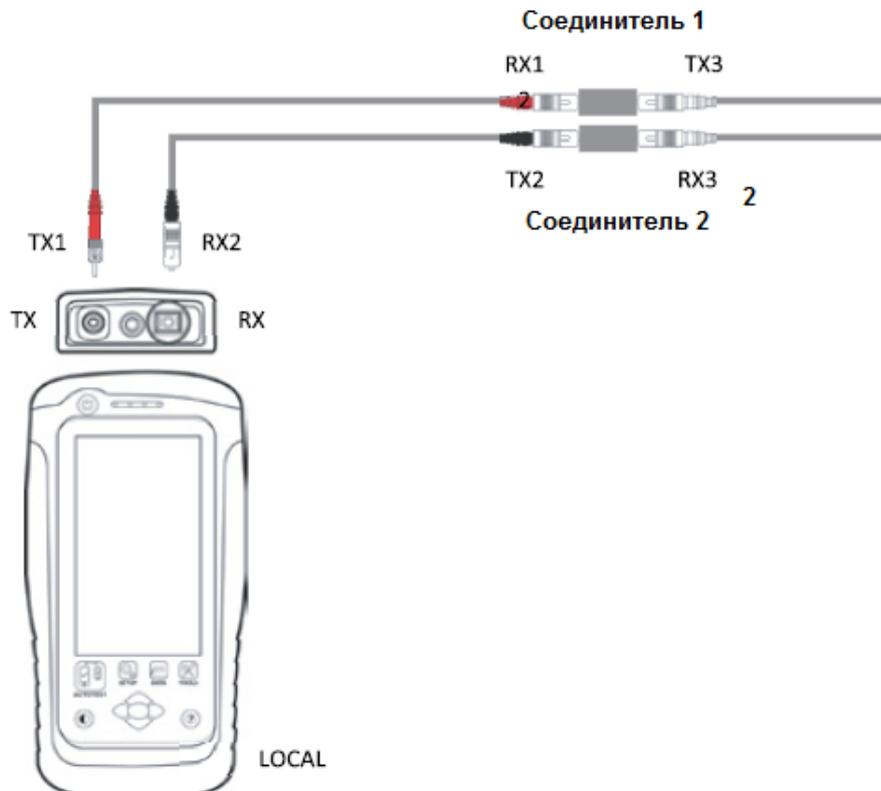
4. Нажмите кнопку [SETUP (Настройка)] → выберите Configuration (Конфигурация) → Three Jumpers (Три перемычки) в колонке Single-Ended (Одностороннее). В зависимости от требований выберите Single (Однонаправленное) или Bi direction (Двунаправленное).
