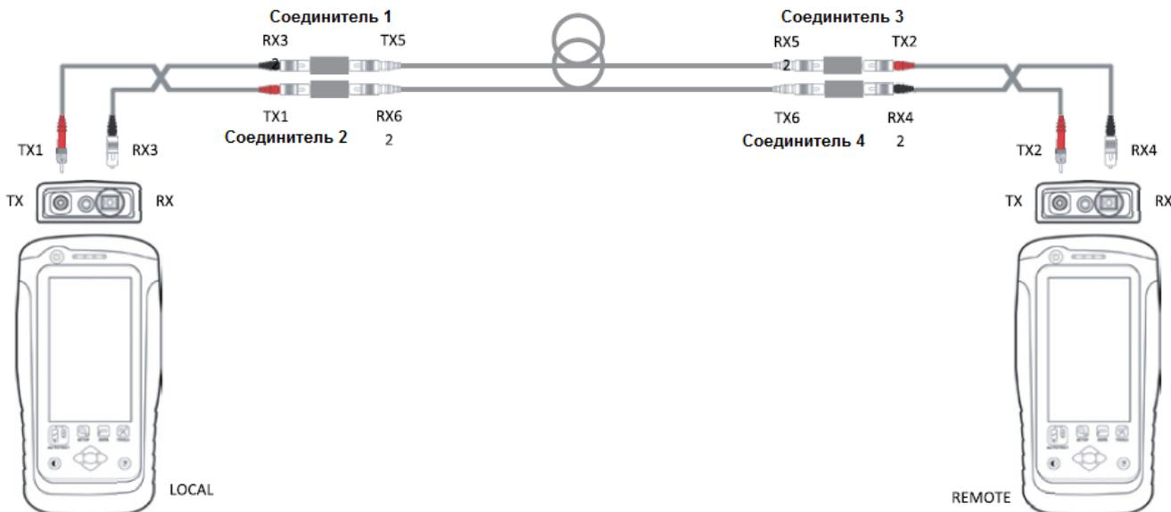
10. Для многомодового режима выберите 850 нм или 1300 нм, а для одномодового режима выберите 1310 нм или 1550 нм, чтобы проверить потери (Loss), предельные условия (Limit) и запас (Margin) для оптического волокна на соответствующей длине волны.
