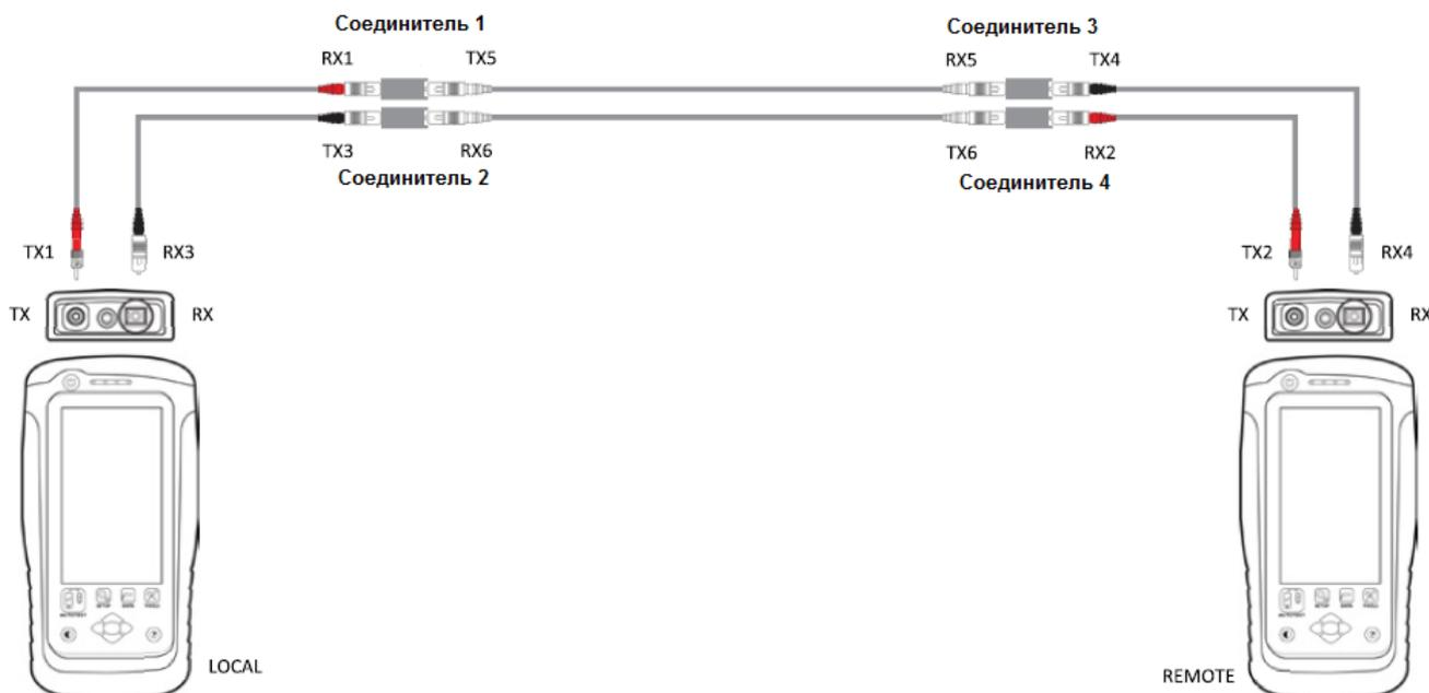
7. Нажмите кнопку [SETUP (Настройка)] → выберите Configuration (Конфигурация) → Three Jumpers (Три перемычки) в колонке Dual-Ended (Двустороннее). В зависимости от требований выберите Single (Однонаправленное) или Bi direction (Двунаправленное).
