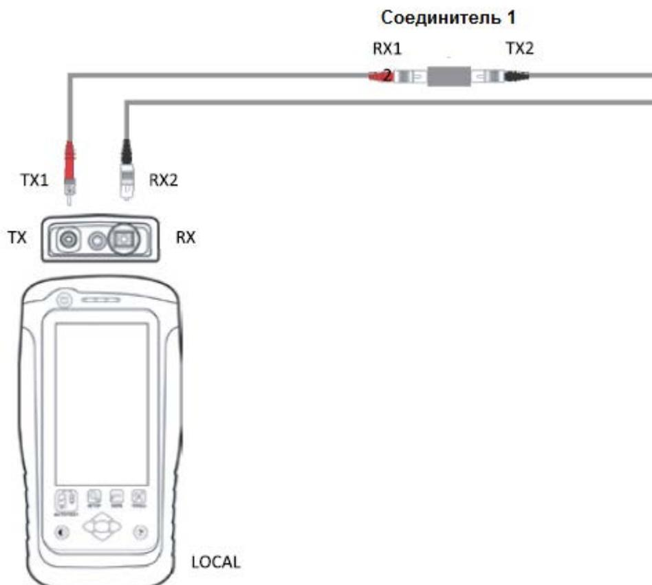
3. Нажмите кнопку [SETUP (Настройка)] → выберите Configuration (Конфигурация) → Two Jumpers (Две перемычки) в колонке Single-Ended (Одностороннее). В зависимости от требований выберите Single (Однонаправленное) или Bi direction (Двунаправленное).
