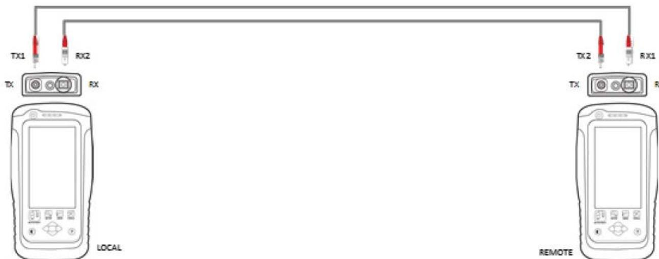
3. Нажмите кнопку [SETUP (Настройка)] → выберите Configuration (Конфигурация) → One Jumper (Одна перемычка) в колонке Dual-Ended (Двустороннее). В зависимости от требований выберите Single (Однонаправленное) или Bi direction (Двунаправленное).
