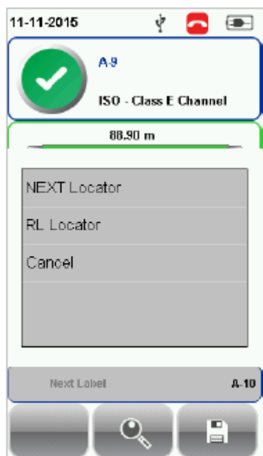
Locator (локатор) – Для включения нажмите кнопку SETUP > выберите Test Settings (настройки тестирования) > Test Options (опции тестирования) > Locator (локатор).
